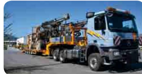
HEGGLI 11 Transport einer Tunnelbohrmaschine.
