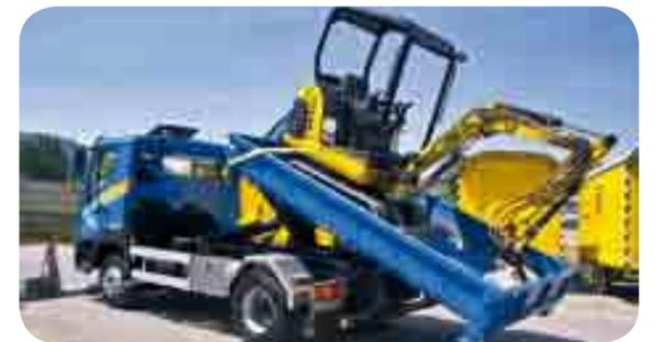
2-ACHS-MINI-ABROLLER mit 3-m<sup>3</sup>-Mulde mit Bagger.
