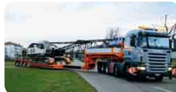
HEGGLI 18 mit Hitachi 47 t; Gesamtlänge 24 m. Transport eines Raupenkrans.
